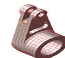
MARCA A3 MATERIAL: ASTM A36 ESPESOR: 8 MM CANTIDAD: 1 C/U PESO UNITARIO: 398 [KG] ESCALA 1:12
