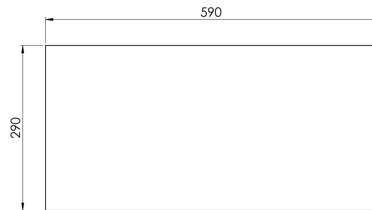
MARCA A12 MATERIAL: ASTM A36 ESPESOR: 10 MM CANTIDAD: 4 C/U PESO UNITARIO: 14 [KG] ESCALA 1:4
