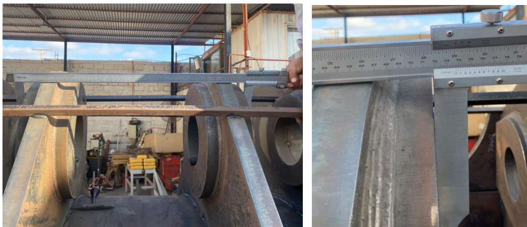
Figura N°5 : Medición con pie de metro la distancia entre orejas en la zona del Link del Balde es de 738 [mm]
