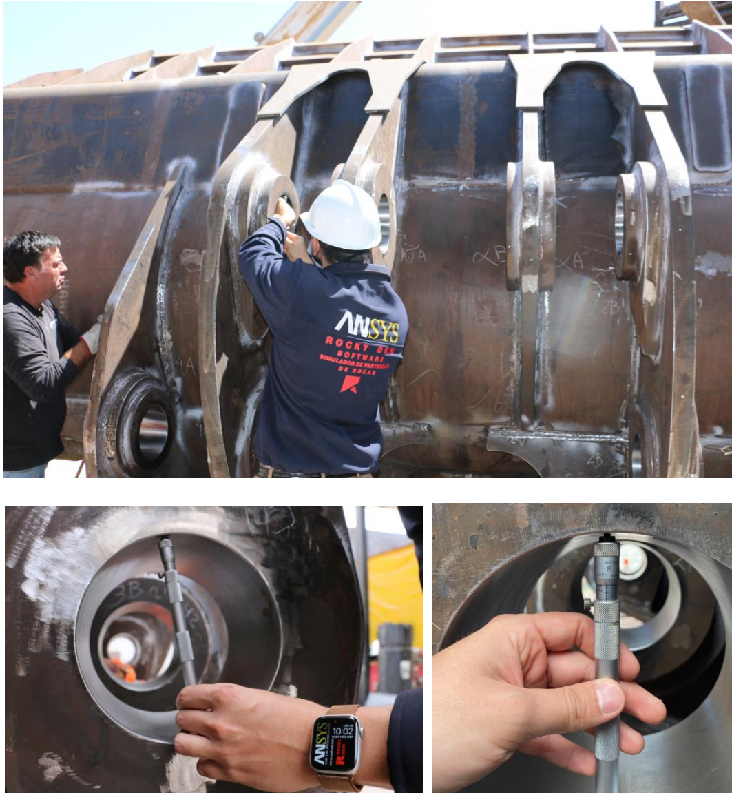
Figura N°13: Mediciones realizada al diámetro del balde con micrómetro en la Maestranza
