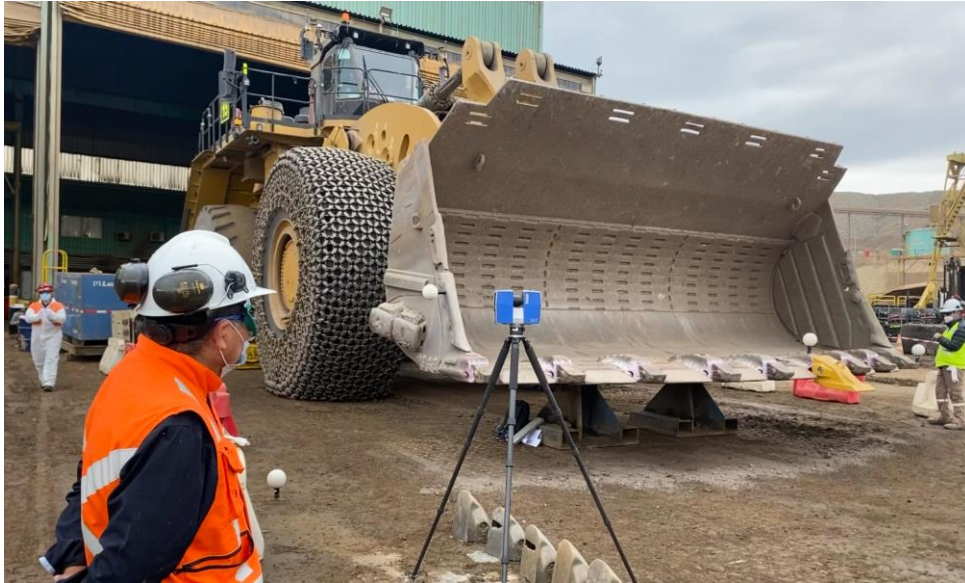
Figura N°7: Escáner 3D en terreno, Minera Mantoverde.
