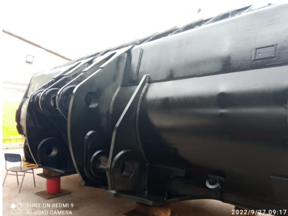
Figura N° 1: Fabricación del Balde CAT 994K
