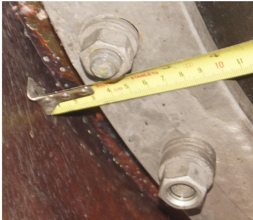
Figura 4: Medición de ancho del anillo mayor diámetro, A=68 mm
